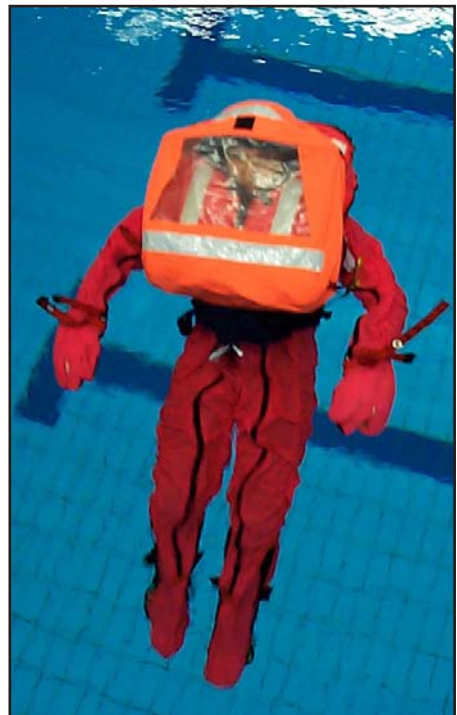
MRS-KSA aktiviert mit angelegtem Kälteschutzanzug und Spritzschutzhaube
