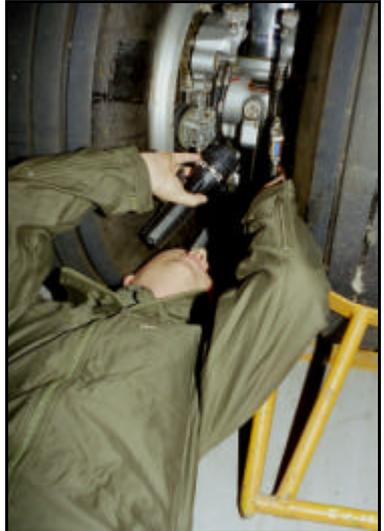
Abdichten einer Ölleckage an der Radbremsanlage
