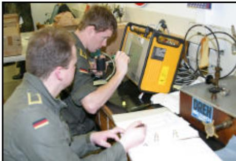
Kontrolle Abgastemperaturanzeige einer Hilfsturbine
